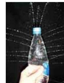
Мал. 167. Саморобний прилад для демонстрації закону Паскаля
