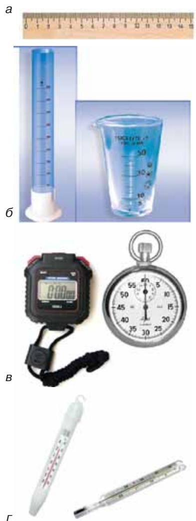
Мал. 6: а — лінійка; б — вимірювальний циліндр, мензурка; в — секундоміри: електронний та механічний; г — термометри
