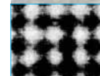
Мал. 24. Фотографія золотої фольги, одержана за допомогою електронного мікроскопа
