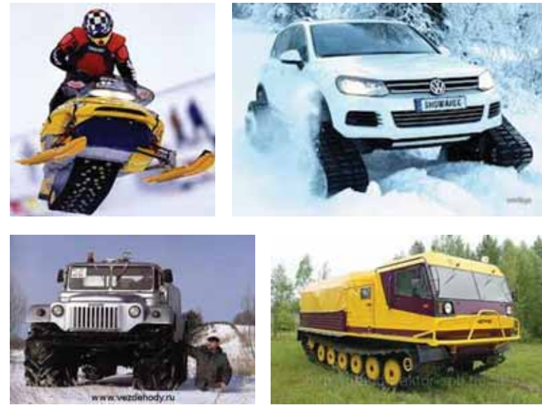
Мал. 149. Для зменшення тиску колеса транспортних засобів роблять ширшими
